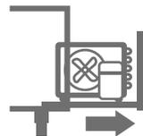
Выдвигаемый агрегатный узел кассетного типа. Легкое обслуживание и быстрая замена
